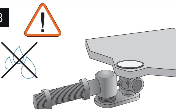
Verificare la presenza di perdite d'acqua. Eventualmente controllare di aver collegato correttamente i componenti.
